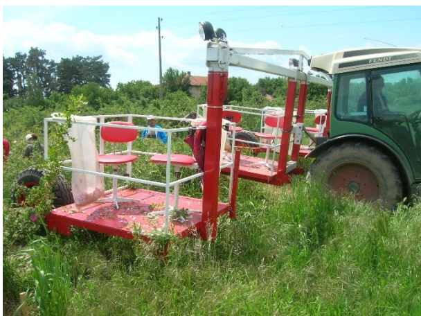
Фигура 2. Тримодулна машина за бране на маслодайни рози
