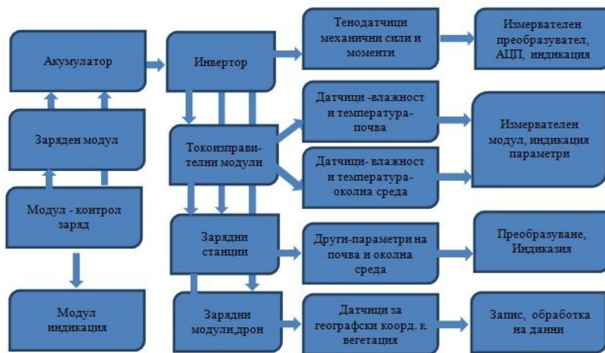
Фигура 1. Блок-схема на измервателна система
