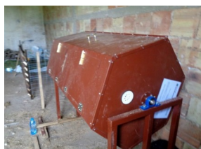
Фигура 1 Ротационна затворена система за ускорено термофилно компостиране
