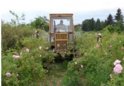
Многофункционална машина за полагане на грижи за растенията и бране на цвета в розовите насаждения
