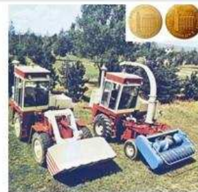
Самоходен силажкомбайн в три варианта - с хедер (вляво), с челен товарач и подбирач (вдясно)
