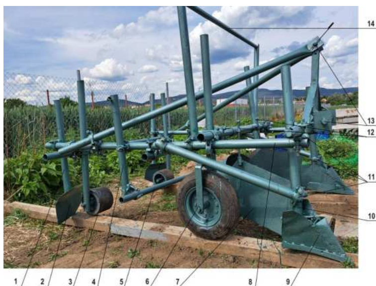
Фигура 1. Комбинирана машина формиране на лехобраздова повърхност с висока дъгообразна леха, полагане на капкови маркучи и мулчфолио
