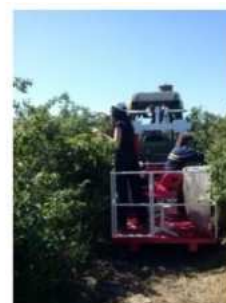
Многофункционална машина за полагане на грижи за растенията и бране на цвета в розовите насаждения
