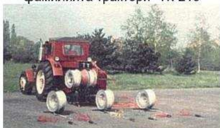
Агрегат резитбен пневматичен АРП-12
