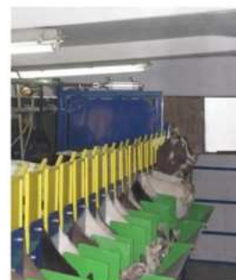
Модулна технология за машинно доене на кози при подредено фиксиране
